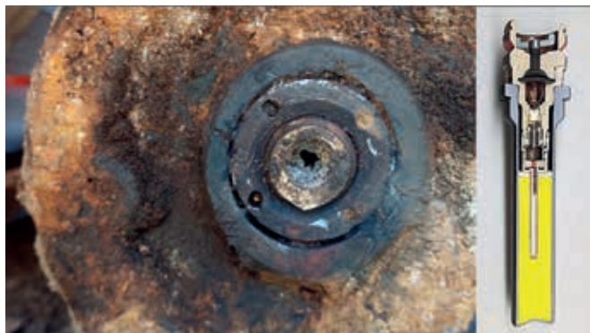
Pohled na „očistěný“ zapalovač s vyobrazeným řezem zapalovače
