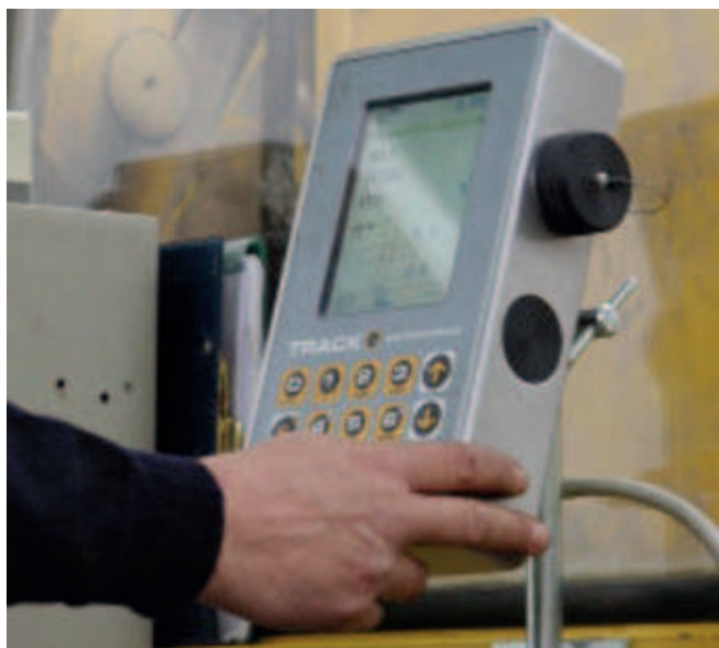
Obrázek 2: TRACK DR-záznamové zařízení
