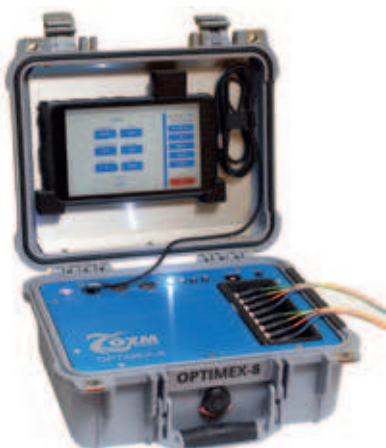
Přístroj pro měření detonační rychlosti a tlaku OPTIMEX-8
