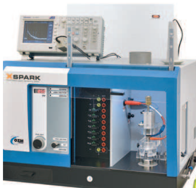
Přístroj ke stanovení citlivosti k elektrostatickému výboji X SPARK 10
