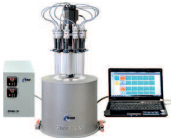
Přístroj STABIL pro testování stability a kompatibility
