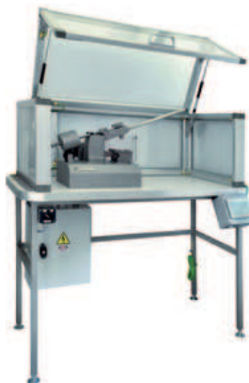
Přístroj pro stanovení citlivosti ke tření FSKM 10
