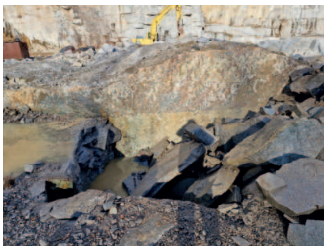
Obrázek 3: Hladký výlom, uvolnění nepoškozeného bloku
